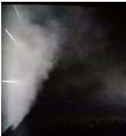
Bild 1a: Raumströmungsaufnahme, Beginn Rauchzugabe, 70 m³/h und -4 K
