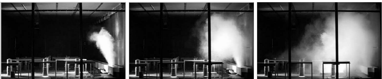
Raumströmung von Induktionsgeräten Typ HFG-./.../MQ mit Fächereinsatz für Misch-Quellströmung (Rauchaufnahme in drei Zeitschritten)
